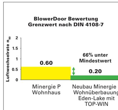
▲ Die Überbauung Eden Lake Wilen wird dem MINERGIE-P® Standard gerecht. Dies entspricht dem internationalen Passivhaus Standard. Die hochwertigen Fenster von 1a hunkeler fenster AG tragen dazu bei, dass der vorgegebene Mindestwert deutlich unterschritten wird.
